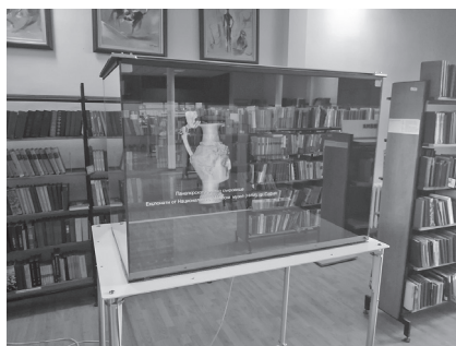
Фиг. 6. Изработената по проекта холограмна система за виртуална реалност
